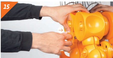
Setzen Sie das Messer ein. Drücken Sie bis Sie ein "Klick" hören.
