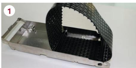
1 Introduire la bande de filtration dans le rouleau à l'intérieur de la pièce inox.
