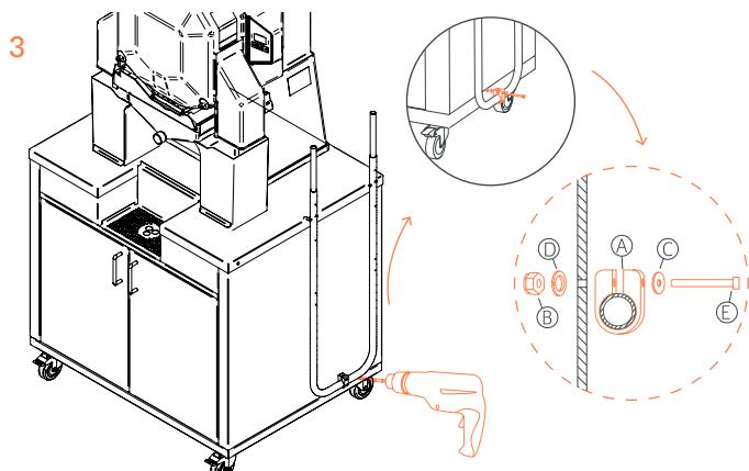
Perforar, colocar y asegurar las fijaciones inferiores ( $\varnothing 4,5$ ).
