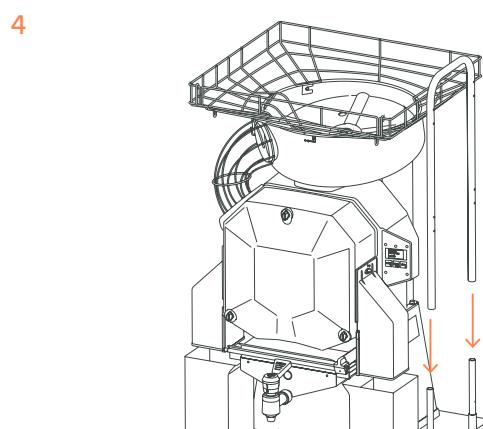
Ensamblar la parte superior de la fijación para bandejas.
