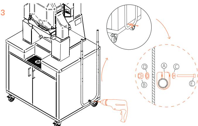
Percez, positionnez et fixez les fixations inférieures ( $\varnothing 4,5$ ).
