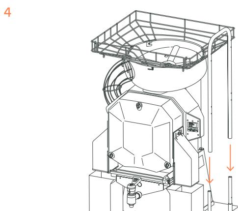
Assemblez la partie supérieure de la fixation pour les plateaux.
