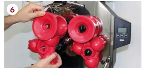
**6** Schrauben Sie die Befestigungsknöpfe der Presseinheiten ab. Nehmen Sie die Presseinheiten paarweise ab.
