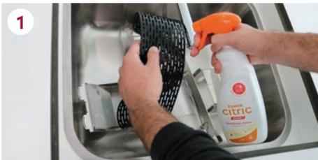
1 Sprühen Sie die Teile mit Citric Active ein und lassen Sie es 30 Sekunden lang einwirken.
