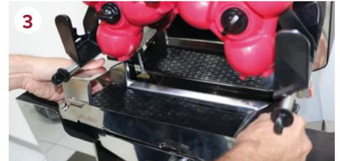
**3** Nehmen Sie das **automatische PulpOut-System** ab, indem Sie die Baugruppe mit dem Teil anheben, das Ihnen am nächsten liegt.
