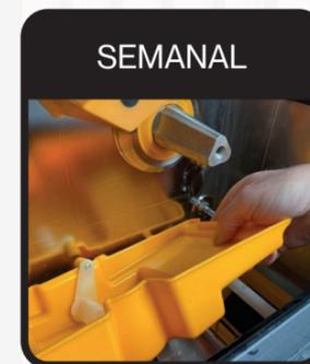
Desmontaje piezas extraíbles. Limpiar cápsula en profundidad..
