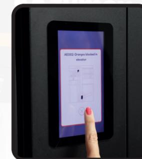
Si no hay puertas abiertas, presionar X para que desaparezca el error.
