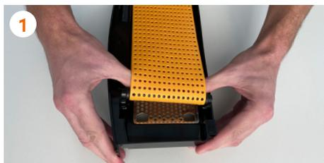
**1** Placez le système PulpOut sur une surface lisse, placez vos doigts sur l'intérieur du **rouleau de la courroie de balayage** et poussez-le vers l'extérieur pour le libérer.
