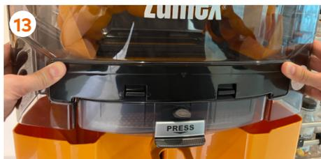
13 Appuyez ensuite sur les deux côtés supérieurs du PulpOut jusqu'à ce que les deux boutons-poussoirs dépassent vers l'extérieur et soient alignés avec les lignes qui dépassent sur le devant.
