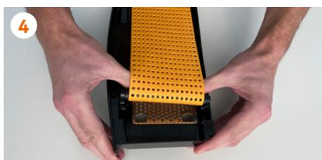
4 Placez le filtre sur une surface. Montez d'abord le rouleau gauche, insérez le deuxième rouleau et tendez la courroie jusqu'à ce que le rouleau soit monté dans son logement.
