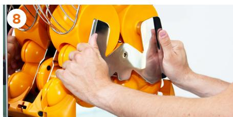
8 Insérez l'ensemble du kit d'extraction dans les axes de fixation.
