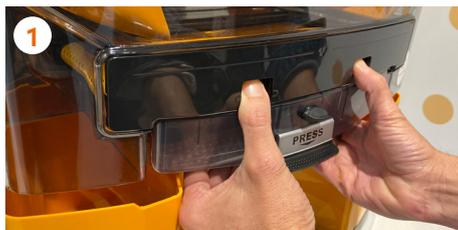
**1** Appuyez sur les deux boutons-poussoirs jusqu'à ce que les deux pièces soient libérées du capot.
