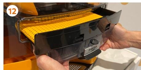
12 Insérez le plateau à jus et le PulpOut ensemble. Tenez le réservoir, mettez-le sur les rails de guidage du capot et poussez jusqu'à ce qu'il soit complètement inséré.
