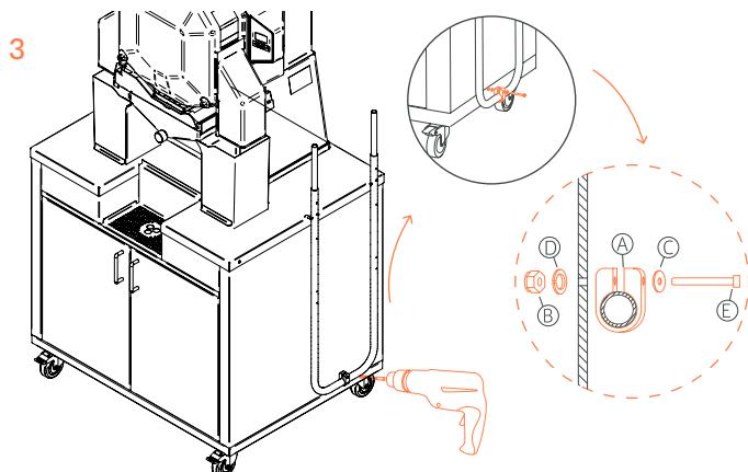
Bohren Sie die unteren Befestigungen, setzen Sie sie ein und sichern Sie sie ( $\varnothing 4,5$ ).
