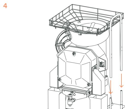
Montieren Sie den oberen Teil der Befestigung für die Ablagen.
