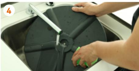
4 Reinigen Sie den **Zuführungsteller** mit Citric Active und einem weichen Schwamm und entfernen Sie alle Rückstände, die sich daran festgesetzt haben.
