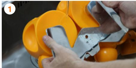
1 Mit Citric Active gemäß den Schritten für Reinigung und Hygiene abwaschen. Drehen Sie an den **Trommeln**, um sicherzustellen, dass alle Bereiche derselben sauber sind.
