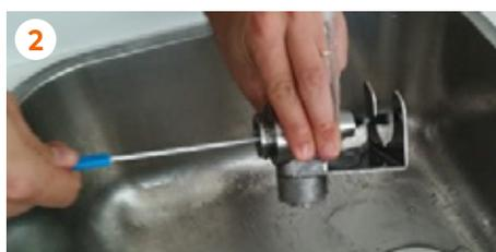
2 Das Entfettungsmittel mithilfe der Sprühdüse durch die drei Löcher auftragen. Mithilfe der kleinen mitgelieferten Bürste die Innenseite der Löcher abbürsten.
