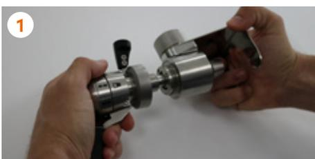
1 Die Oberseite des Hahns durch Herausdrehen des Gewindes demontieren und die zuvor angegebenen Reinigungsschritte befolgen.
