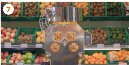
7 Den vorderen Bereich der Maschine gemäß den zuvor beschriebenen Anweisungen reinigen.
