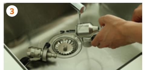
3 Mit Wasser abspülen, das Desinfektionsmittel auftragen, erneut abspülen und abschließend sowohl außen als auch innen mit Papier abtrocknen (das Papier auf den Drehzapfen aufwickeln, um das Einführen des Papiers in die Öffnungen zu erleichtern).
